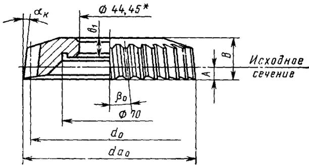
\* Допускается изготавливать долбяки с диаметрами посадочных отверстий 31,743, 44,443, 31,75 мм вместо 44,45 мм.
